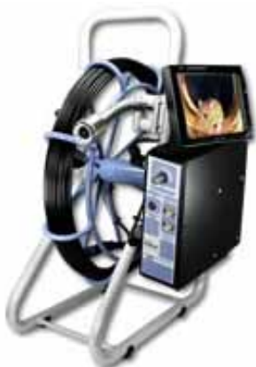
Kanalkamera für Leitungen mit kleinem Durchmesser, z.B. Liegenschaftsentwässerung
